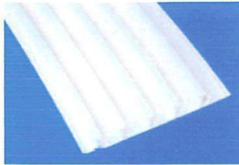
O enrolamento dos perfis de PVC é efetuado por intermédio de um equipamento de pequeno porte, capaz de fabricar tubos de diferentes diâmetros e comprimentos. Essa simplicidade e versatilidade do equipamento permite que a fabricação dos tubos seja efetuada na própria obra, sendo também possível o fornecimento dos tubos já confeccionados.
